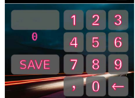
Fotografia 4. Komunikaty na wyświetlaczu: a) strona główna spalanie chwilowe i średnie, b) podgląd podstawowych parametrów pracy silnika, c) strona kalibracji – można wprowadzić ilość zatankowanego paliwa
